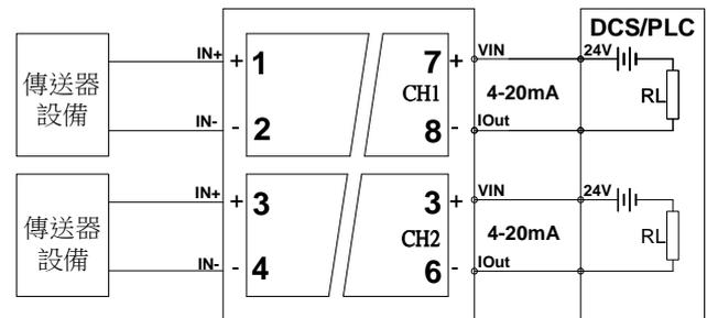
輸出迴路供電應用接線圖(無帶電壓輸出)
