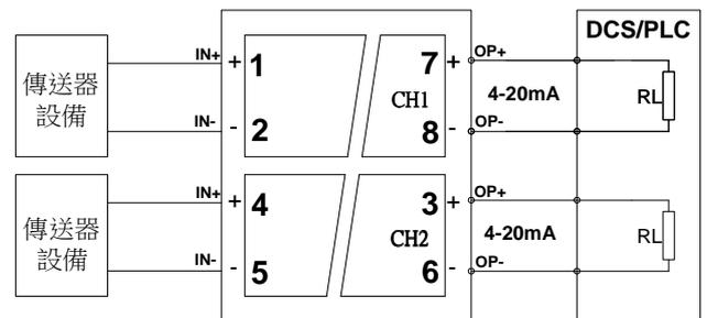
電流源輸出應用接線圖(帶電壓輸出)
