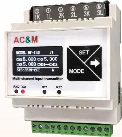
MP15 系列設計為小型軌道安裝顯示電錶，利用拼接擴充方式設計，主機 3 通道輸入，可以再擴充 4 台 (SP15) 可達 15 通道輸入。同時具備標準 RS485 Modbus 輸出通信介面，通信、電力監測整合式工業 4.0 架構，可適用於各種不同電力回路，馬達控制盤電量監控。
